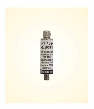
Codice Articolo Descrizione Caratteristiche Frequenza di taglio 782MHz Filtro TV passa basso Perdita di inserzione tip. <2 dB per attenuare Attnenuaz. a 806 MHz >45 dB B091882 LPF 782-F interferenze <u>forti</u> Attnenuaz. a 822 MHz >67 dB dei segnali LTE Return loss >12 dB - Uso interno -Connettori IN/OUT - F
